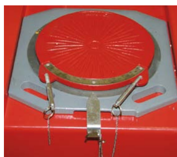
OBROTNICE POD PRZEDNIE KOŁA POJAZDU
